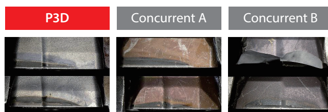
Comparaison d'usure après perçage de 48 trous
