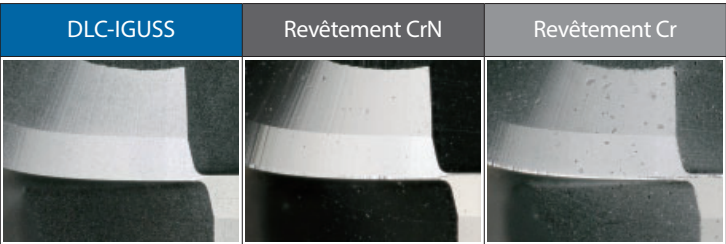
État d'usure du flanc après fraisage 420m
