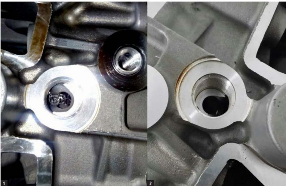
1. Le problème d'évacuation des copeaux était un réel souci pour le client dans leur production de bloc de moteur cylindre en aluminium. Les morceaux de copeaux devaient être retirés manuellement à chaque fois, ce qui affectait la stabilité et l'efficacité de production.
