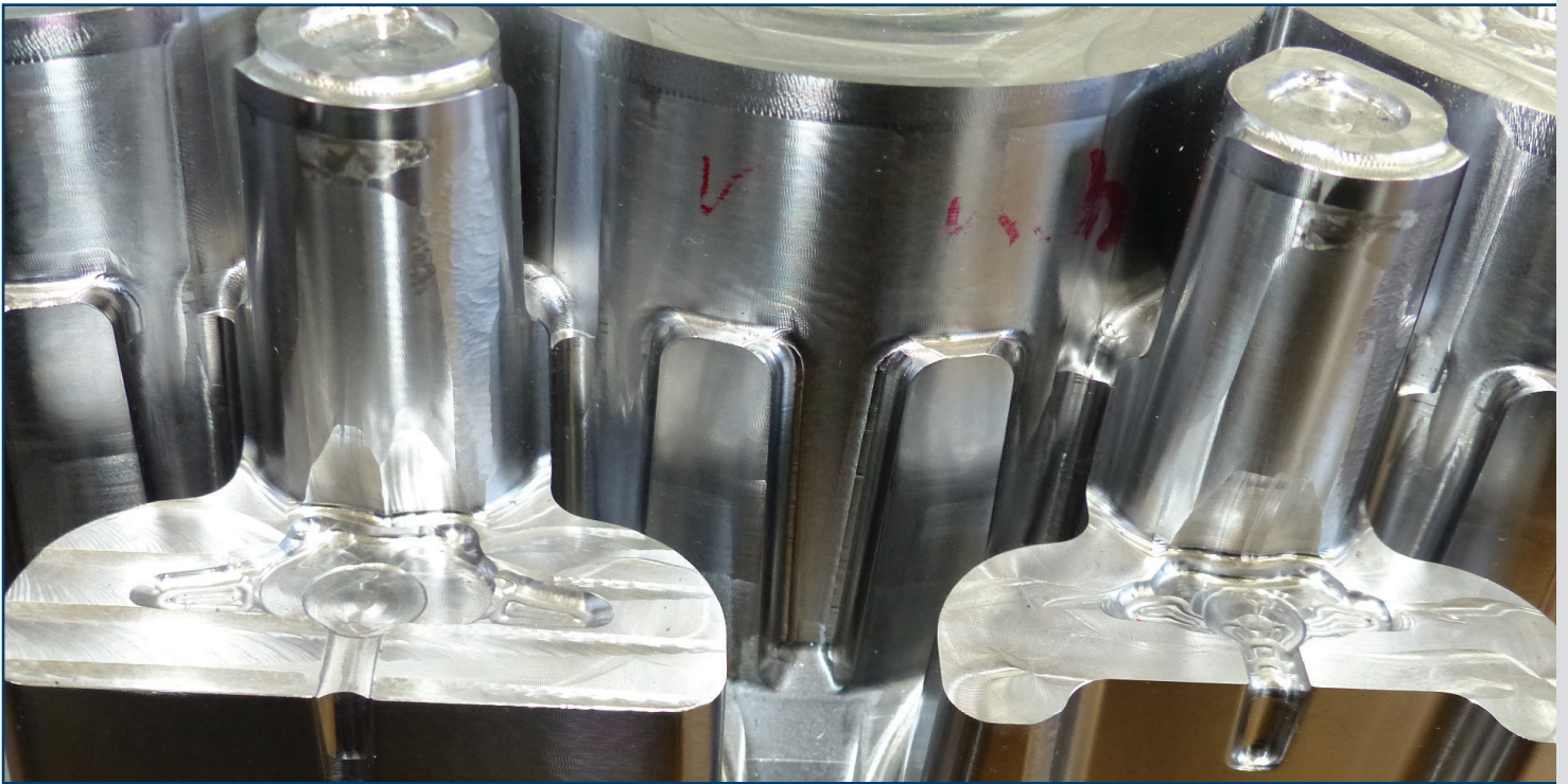
Avec l'intégration des outils de fraisage OSG, il a été prouvé que même l'usinage 3 axes peut être largement plus efficace que l'usinage 5 axes, lors de la réalisation de chemises de refroidissement composées de trous profonds et étroits.
