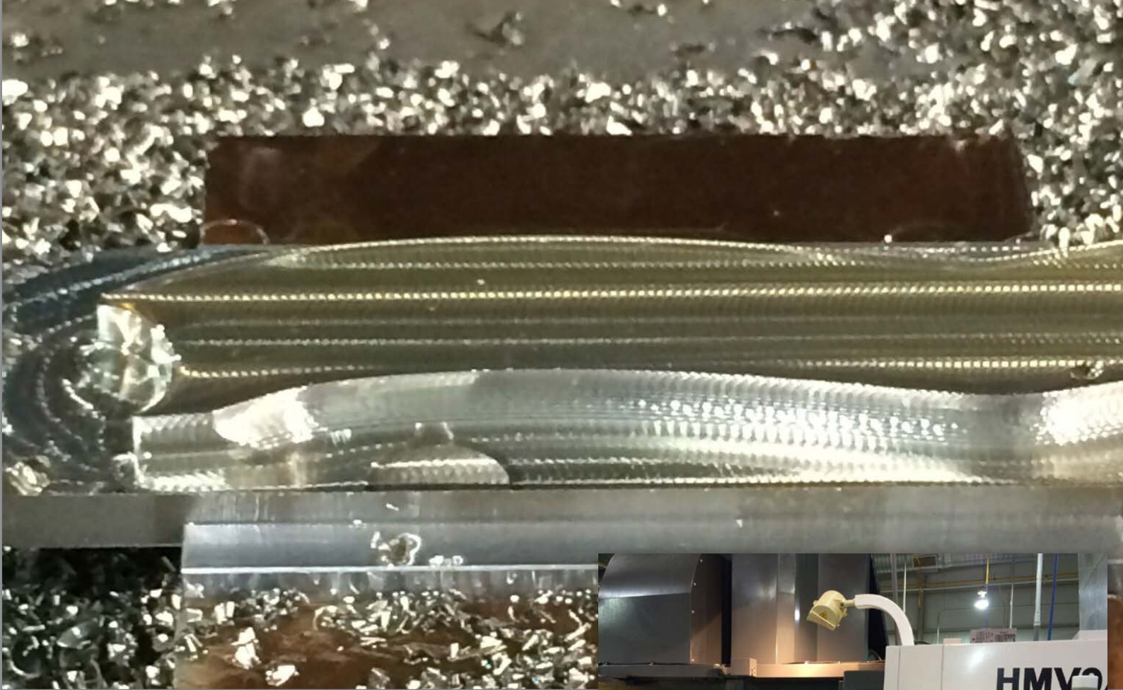
La pièce de turbine RENE 41 (40 HRC) avec une dimension de 70mm x 203mm x 25,4mm.
