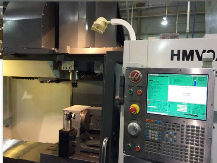
Le fraisage de face de la pièce RENE 41 dans le centre d'usinage horizontal de Paradigm Precision, en utilisant de l'huile blasomill comme lubrifiant.
