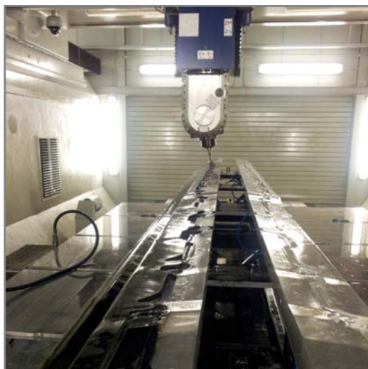
Les poteaux Z sont fabriqués dans des machines de fraisage FOG précision à 5 axes.
