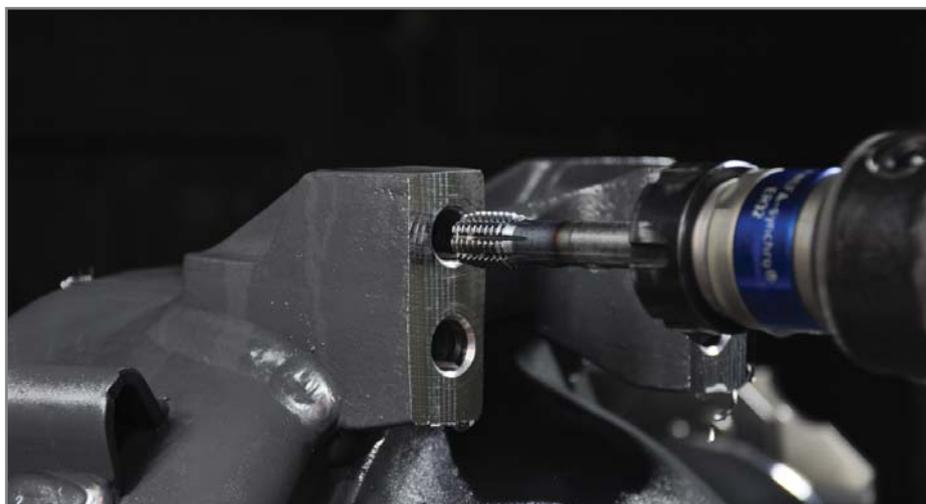
Le XPF est un taraud à refouler haute performance qui ne produit aucun copeau et qui est optimisé pour l'usinage dans des matières jusqu'à 35 HRC.
