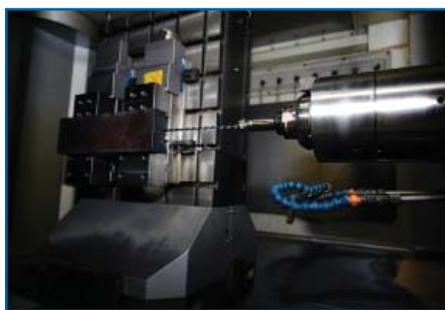
La série ADO est la série phare de forets carbures à trou d'huile d'OSG, conçue pour exceller dans une large variété de matériaux. La série se compose d'une gamme complète avec des tailles disponibles jusqu'à 30x le diamètre.
