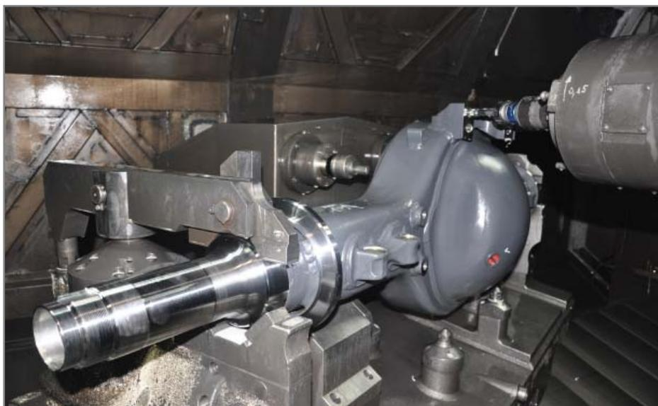
Le XPF est utilisé pour le filetage des boîtiers de différentiel.
