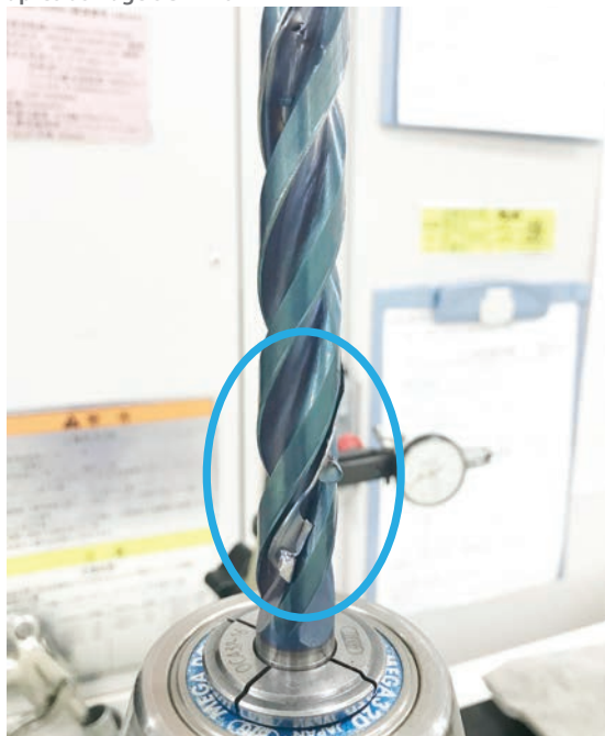
Figure 3, état du foret conventionnel 3 lèbres après usinage SCM440
