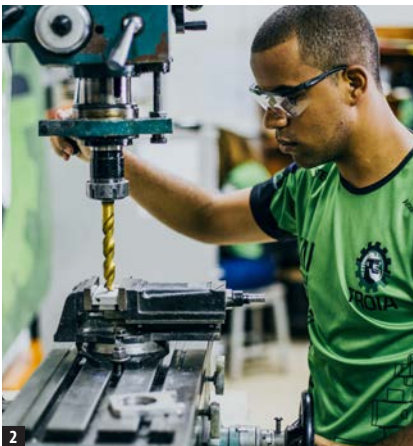
2. Thales Roger de TROIA, utilise un foret OSG pour usiner une pièce de la structure du robot.
