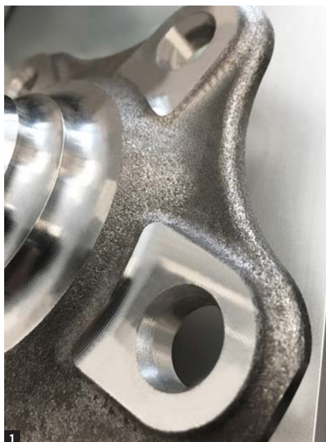
1. Chaque palier de moyeux de roue de NTA nécessite le perçage de 5 trous dans de l'acier au carbone S53C. NTA produit environ 840000 pièces par an, soit 4 200 000 trous.
