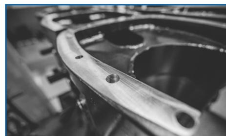
En haut : Avant le taraud par déformation XPF, Valtra utilisait un taraud coupant pour le filetage de leurs réservoirs dans de l'acier SAE 1020, mais était préoccupé par des problèmes de nidifications.
