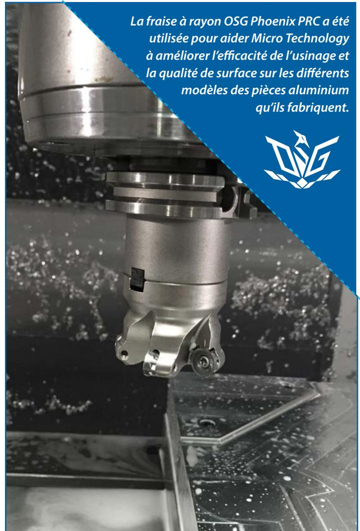
*La fraise à rayon OSG Phoenix PRC a été utilisée pour aider Micro Technology à améliorer l'efficacité de l'usinage et la qualité de surface sur les différents modèles des pièces aluminium qu'ils fabriquent.*
